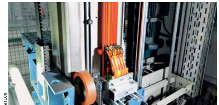
Ergänzende Optimierungsmaßnahme: Die alten Schleppketten der RBGs wurden für eine ungehinderte Stromzuführung durch Schleifleitungen ersetzt. Die Datenübertragung zum Lastaufnahmemittel erfolgt jetzt über Datenlichtschranken.
