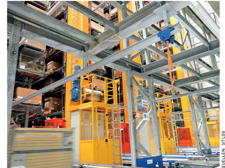
3 Das ZF-Paletten-Hochregallager mit sechs Regalbediengeräten wurde im Jahr 2015 komplett überholt.
