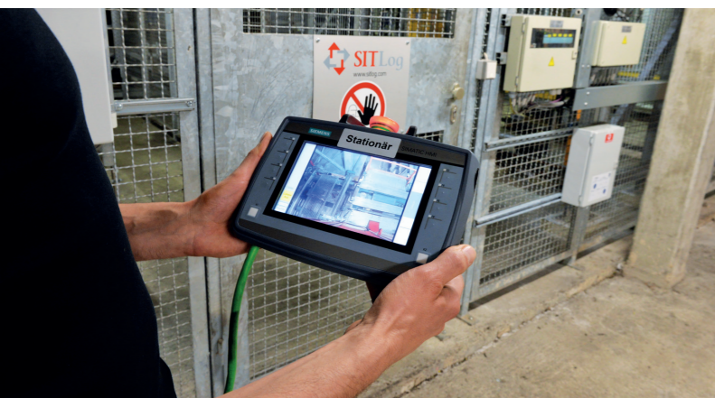
4 Durch Kameras auf den Regalbediengeräten in jeder Gasse sind die Lastaufnahmemittel mit mobilen Panels einseh- und steuerbar.
