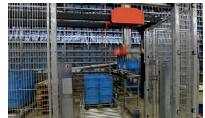
Palettier- und Depalettierroboter für 400 Behälter pro Stunde.
