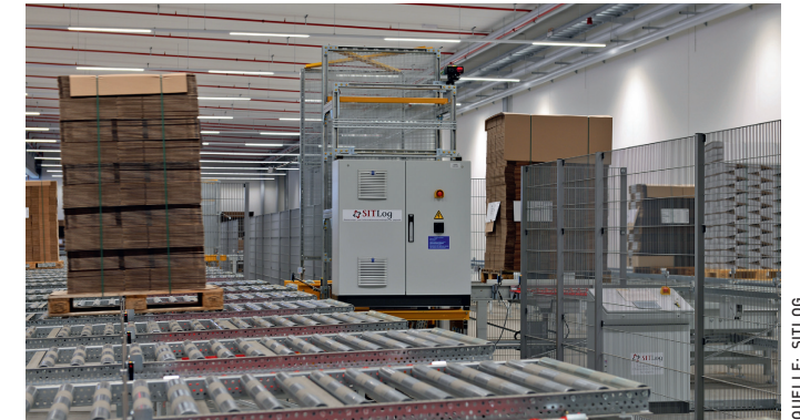
Insgesamt 5 Querverschiebewagen versorgen 30 Versandbahnen, 240 Paletten werden pro Stunde ein- und ausgelagert.
