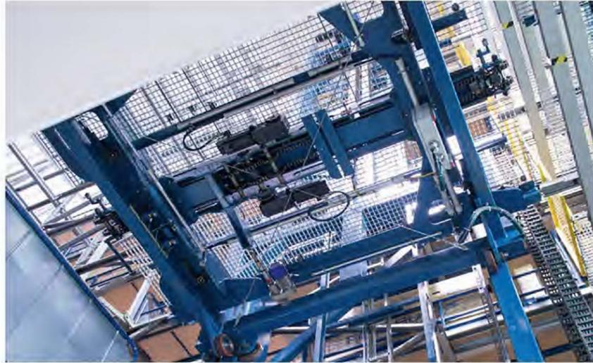
4 Die Lastaufnahmemittel auf den Trolleys und den Hebern und Vertikalförderern sind jeweils mit einem Verschiebebalken und einer Ziehkette ausgerüstet, so dass die Trolleys an den Querverschiebewagen angekoppelt und in die Gassen des Kanallagers hinein geschoben und anschließend wieder heraus gezogen werden können.
