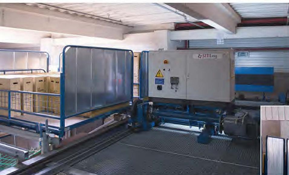
2 + 3 Querverschiebewagen, der die Rollpaletten mit den Maßen 2,6 m x 2,0 m (LxB) jeweils in der Lagerebene transportiert. Die Antriebstechnik und deren Regelung sind jeweils mitfahrend angeordnet. Die S7-Steuerung befindet sich stationär.
