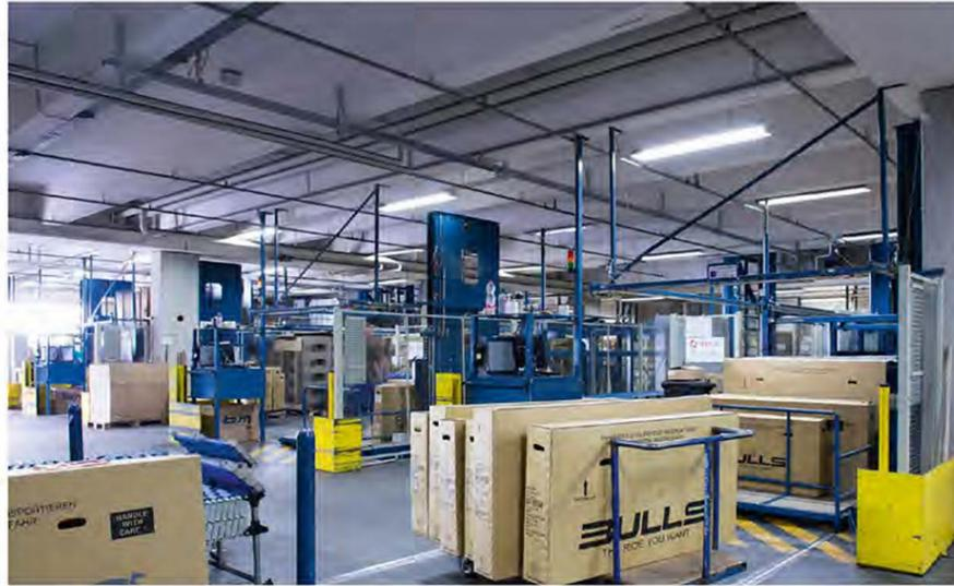
1 Das Erdgeschoss des ZEG-Trolleylagers ist den Funktionsbereichen Warenein- und -ausgang sowie der Kommissionierung und der Sendungsverdichtung vorbehalten. Die vier Vertikalförderer dienen der Ver- und Entsorgung des oberhalb liegenden Lagers. (Bilder: Sitlog)
