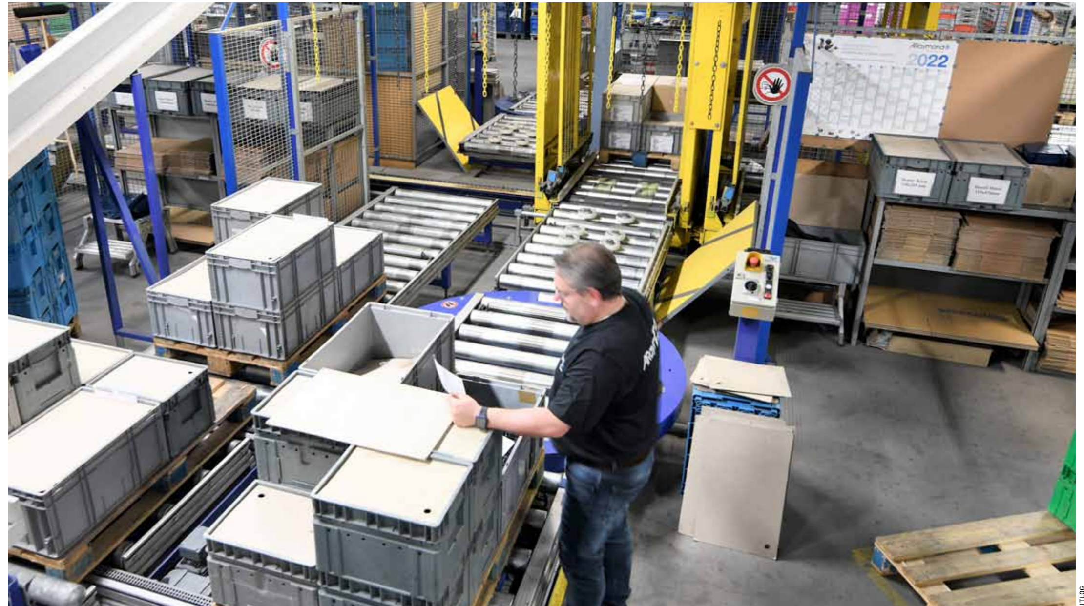
Kommissionierbereich mit Fördertechnik und QVW im Hintergrund
