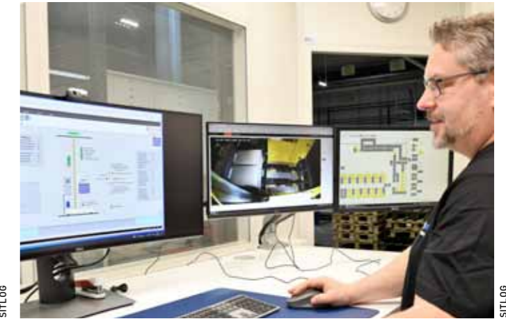
Die einzelnen Anlagenbereiche werden im Leitstand visualisiert. Bei sich anbahnenden oder aktuellen Störungen können direkt korrigierende Gegenmaßnahmen eingeleitet werden.
