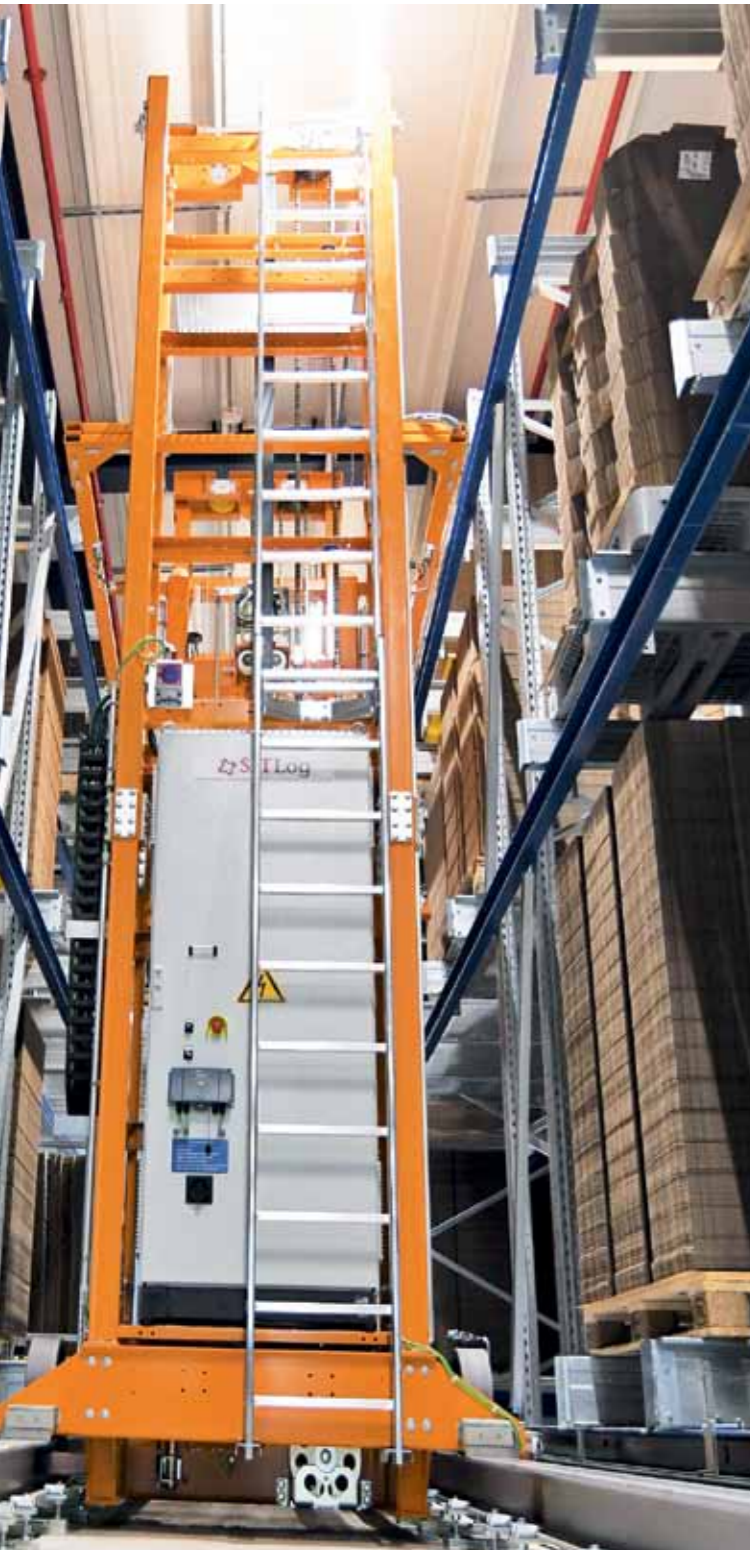
Regalfahrzeug im Satellitenlager mit 800 Stellplätzen, für das bis zu 2.200 Millimeter hohe und 1.800 Millimeter breite Ladegut.
