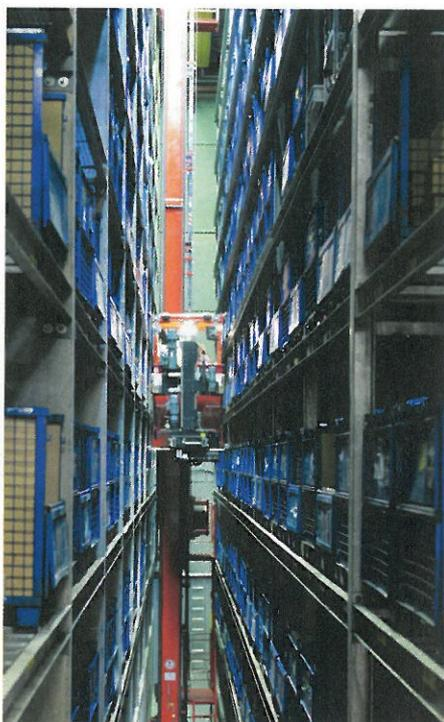
③ Insgesamt wurden in den Gassen des Palettenlagers zwölf Regalbediengeräte ausgetauscht oder neu eingebracht
