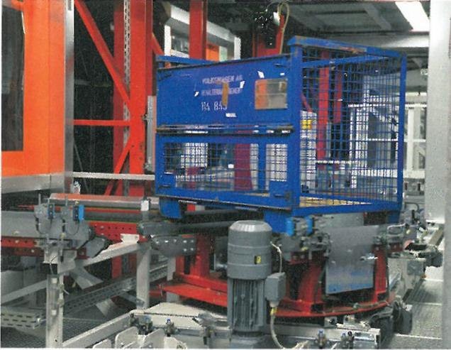
7 Der Doppelquerverfahrwagen in der Vorzone ist mit einem Drehtisch ausgestattet (Bilder: Sitlog)
