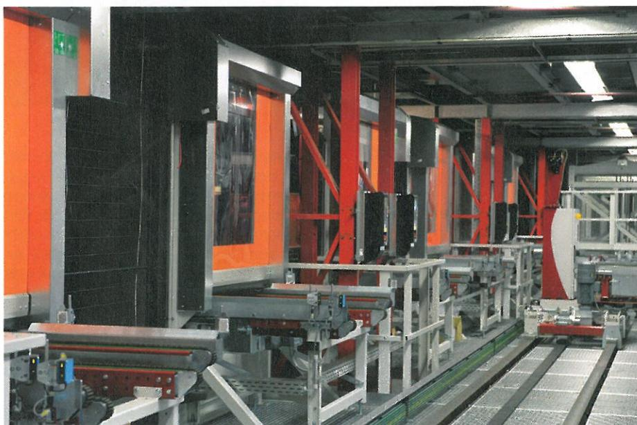
**6** Zur Anbindung der Kommissionierplätze im Automatikbetrieb wurden neue Fördertechnikstrecken in die Vorzone integriert
